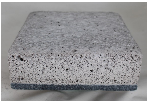
Obrázek 1 Kompozitní blok připravený z lité a lisované geopolymerní desky.
